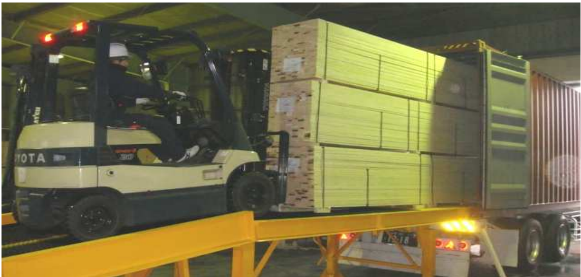
40F海上コンテナよりLVL材取り降ろし作業
